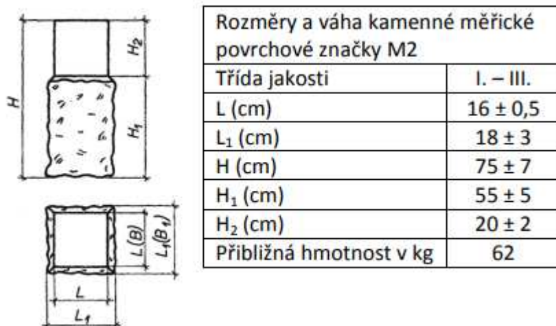
Obrázek 5 Rozměry povrchové kamenné značky M2
